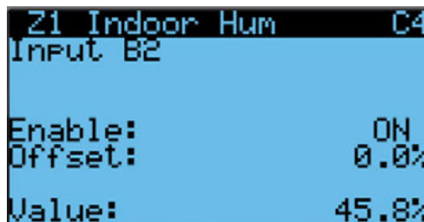
FIGURA 36 Habilitar/inhabilitar sensor de humedad interior de zona 1
