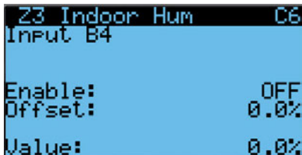
FIGURA 38 Habilitar/inhabilitar sensor de humedad interior de zona 3
