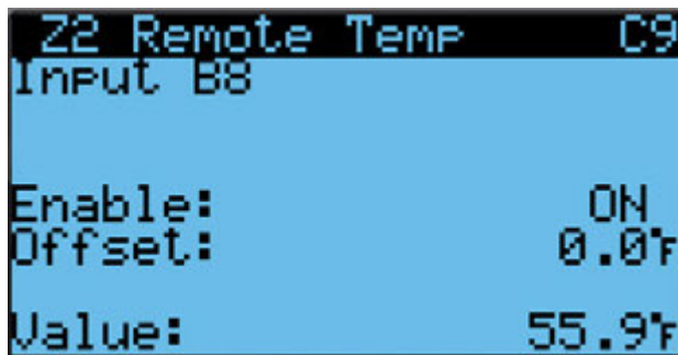
FIGURA 41 Habilitar/inhabilitar sensor de temperatura remoto de zona 2
