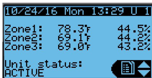
FIGURA 1.16 LC6000 - Pantalla Estado (Status)
